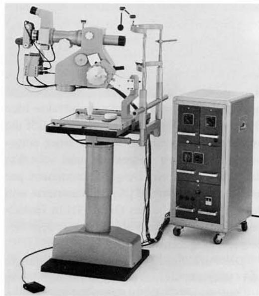
**Abb. 6.** Funduskamera (H. Littmann, ab 1955) mit Automatikzusatz und Schnellblitzgenerator (G. Littmann, ab 1965).
