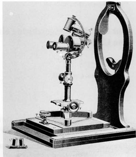
**Abb. 2.** Hornhautmikroskop mit orthoskopisch abbildender Stereoptik (Czapski, 1898).
