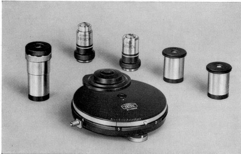
Bild 19: Hellfeld-Phasenkontrast-Dunkelfeld-Kondensor III Z mit Hilfsmikroskop (links), Phasenkontrastobjektiven und C-Okularen.
