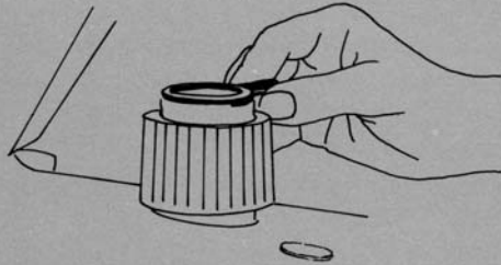
Abb. 46 Auflegen des Polarisators auf den Beleuchtungsstutzen.
