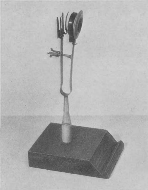
Modifiziertes Zirkelmikroskop. Der Objekthalter ist zum Einklemmen des Tragglasses eingerichtet, die Scharfeinstellung erfolgt durch Drehen der Flügelschraube, die den federnden Linsenträger mehr oder weniger freigibt. Schweizerische Sammlung für Historisches Apotheckenwesen, Basel.
