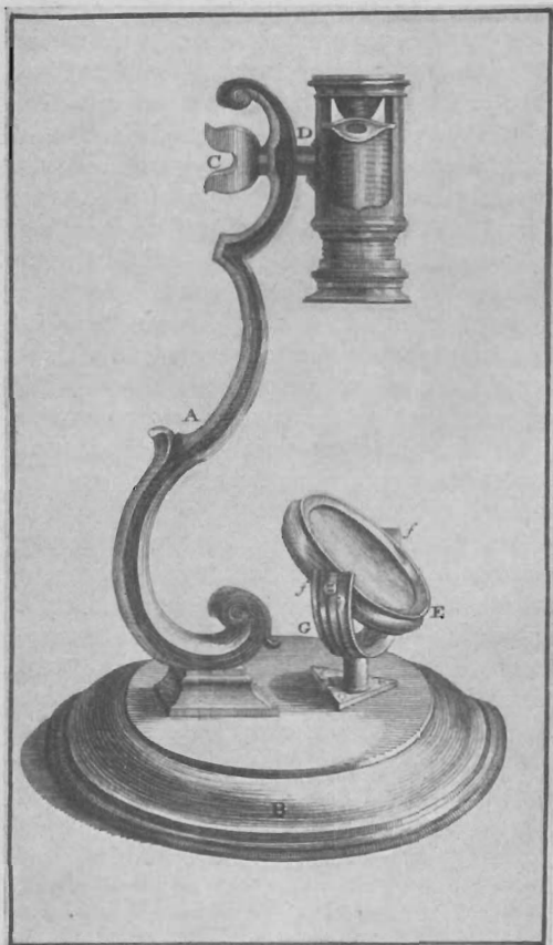
Wilsonsches einfaches Mikroskop mit Spiegel. Der Tubus ist vertikal an die Säule montiert. Nach einer Abbildung aus der holländischen Ausgabe «Het Microscop gemakkelyk gemaakt», Amsterdam 1744, des Werkes «The Microscope made easy» von Henry Baker (1698–1774).
