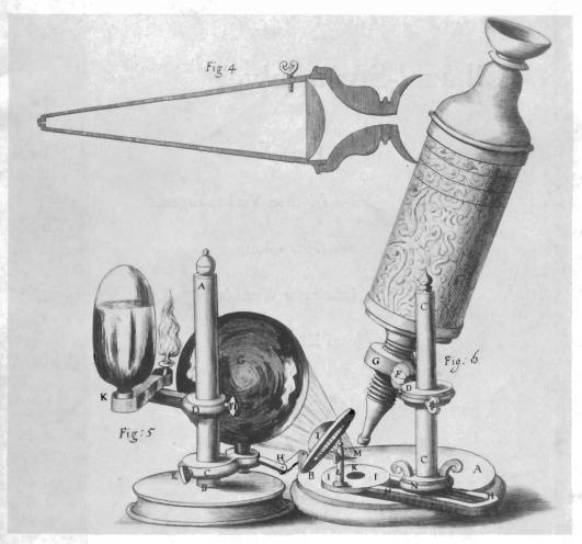
Mikroskop von Robert Hooke (1635–1703), beschrieben und abgebildet in dessen «Micrographia» (London 1665). Zur Grob- und zur Feineinstellung dient ein hölzernes Stativ besonderer Bauart, alle Teile der Beleuchtungseinrichtung sind schon einzeln regulierbar. Figur 4 zeigt im Längsschnitt, daß der Tubus zur Erhöhung der Lichtstärke durch eine seitliche Öffnung mit Wasser gefüllt werden kann.
